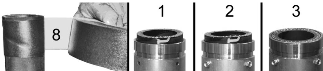
Spiel zwischen dem **Förderschlauch** und der **Schlauchhülse** mit Abdichtband **Pos. 8** ausgleichen. Nur eine Bandbreite abkleben. Schlauchhülse muss ohne Spiel über das Abdichtband zu schieben sein.
